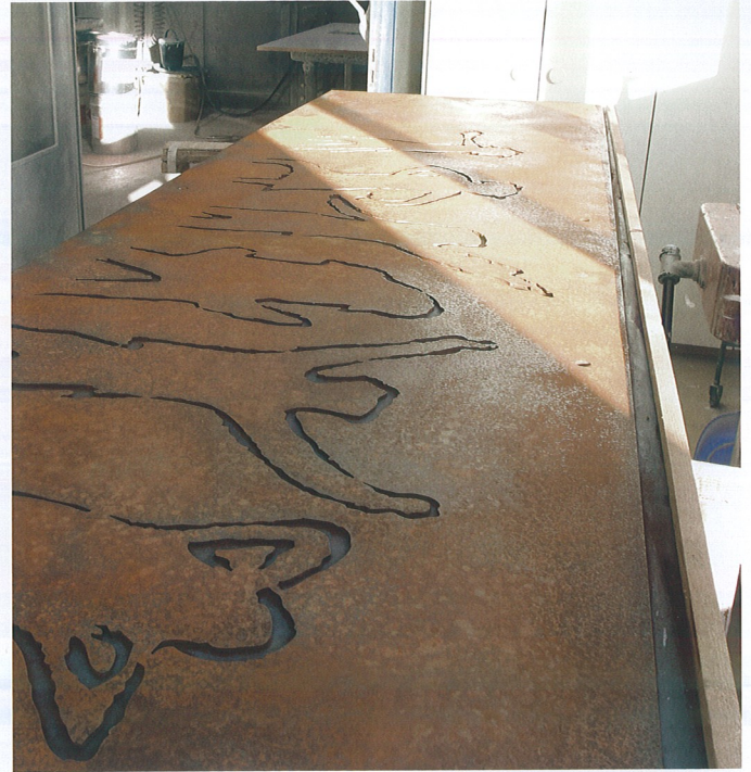
Das Blech für die Barfront mit den ausgelaserten Figuren.
