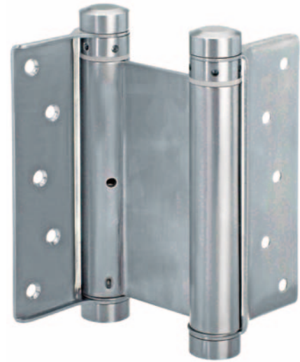
Ein klassisches Pendeltürband. Es lässt dank den eingebauten Spiralfedern den Türflügel immer in die Ausgangsstellung zurückschwingen.
