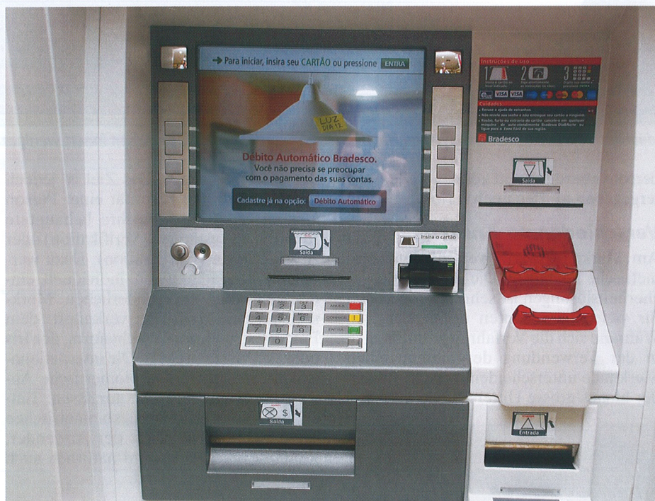
Bancomat der brasilianischen Bradesco-Group mit integriertem Handvenenscanner. Quelle: Bradesco
