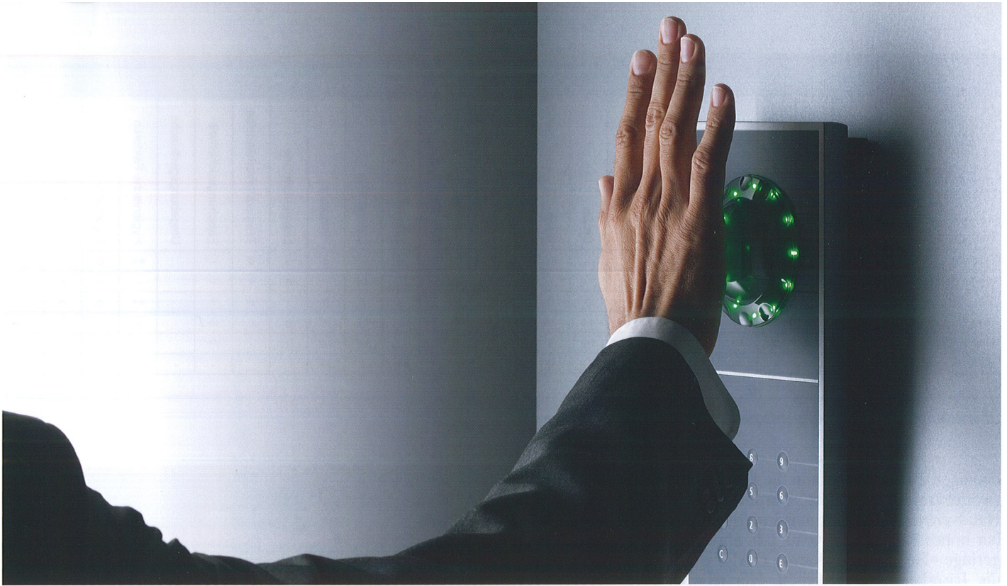
Ideal auch als Zutrittskontrollsystem. Handvenenscanner verrichten ihre Arbeit innert weniger Sekunden. Quelle: INTUS
