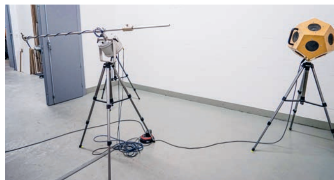
Mit den Geräten für akustische Prüfungen können Werte vor Ort kontrolliert werden.
