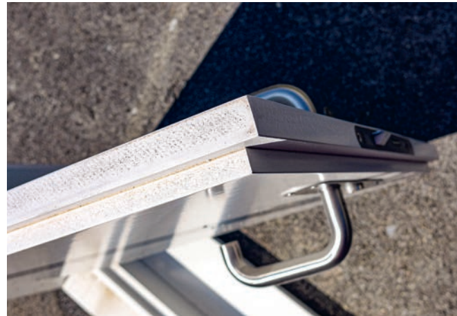
Ob und wie sich ein Türblatt verzieht, lässt sich draussen unter realen Bedingungen feststellen.
