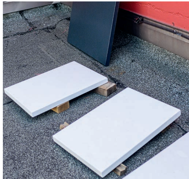
Im Bewitterungstest lassen sich Platten und Oberflächenprodukte beurteilen.
