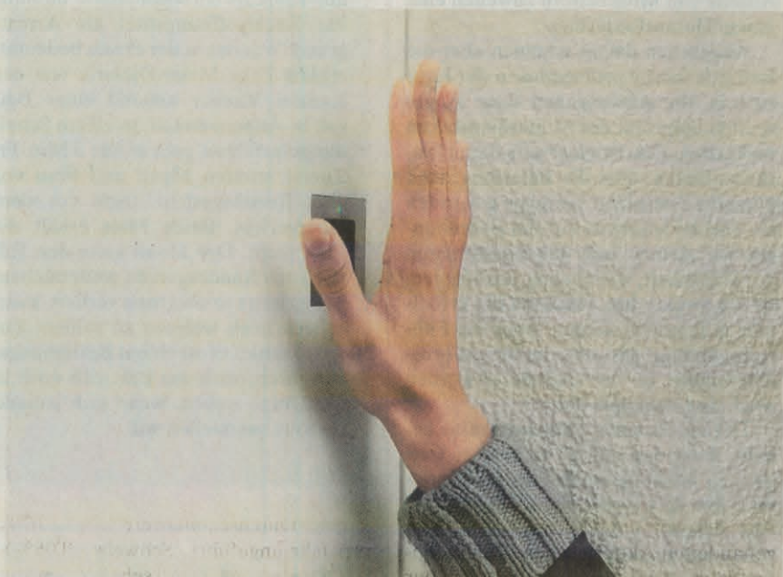
Das Gerät erkennt die Struktur der Handvenen auch ohne Berührung.
