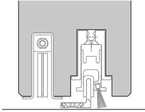
Bodenführung mit Senkdichtung (für verbesserten Schallschutz)
